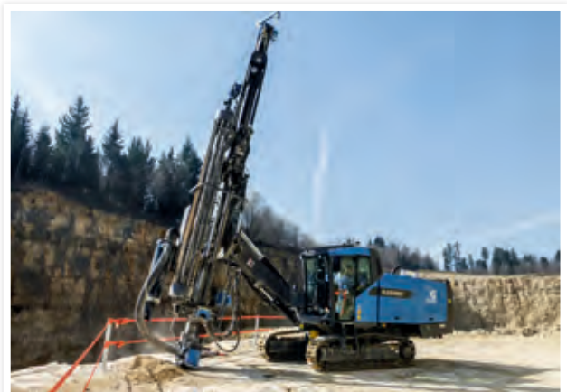
Absteckung oder Aufnahme mit GPS-Stock oder GPS unterstützten Bohrgeräten (Bohrausrichtung).
