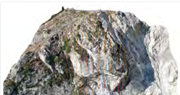
Visualisierung eines Überhangs mit Lage der Bohrlöcher in der Front sowie Austrittstellen am Fuss
